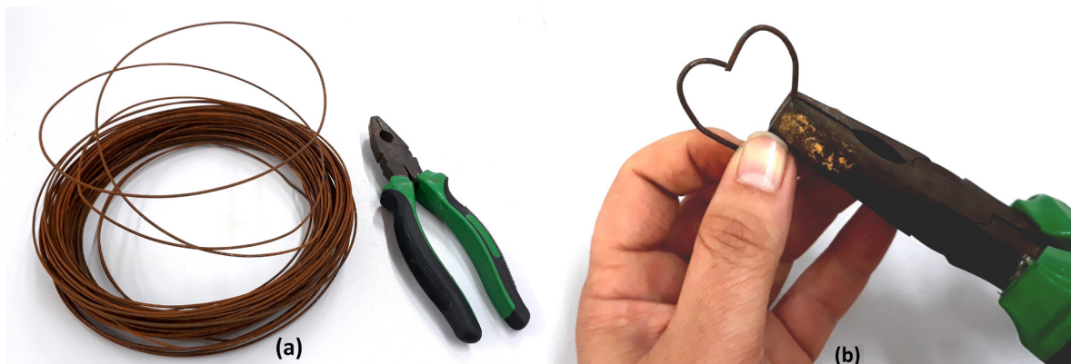
Figura 3: (a) Arame utilizado para galvanização com zinco. (b) Confecção da peça a ser zincada.
